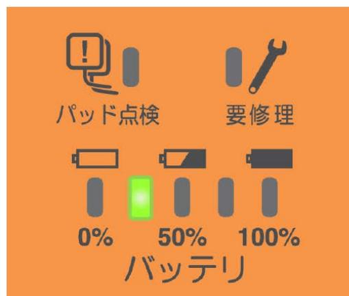
図：バッテリーパックの交換が必要なときのバッテリー残量の表示
